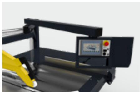
Ein leicht zugängliches, hochauflösendes Touchpanel bietet die volle Kontrolle über die Maschine.
