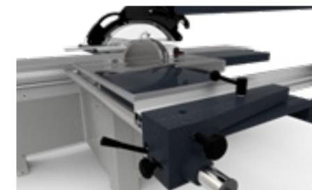
Parallelschlag mit Gusshalterung mit Feineinstellung bis 1.300 mm.
